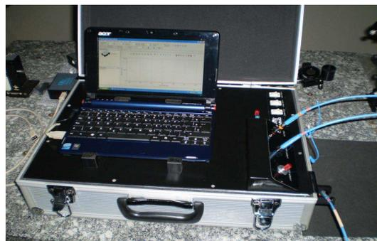
**Figura 6** – Espectrofluorímetro Portátil (MM'OPTICS).
